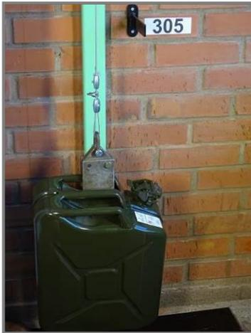
Der Kanister wird mit Wasser gefüllt und aus 305 mm Höhe fallengelassen. Jeder Griff wird geprüft.
