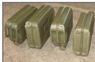
Der Kanister wird mit Wasser gefüllt und wird von 1,2 m oder 1,8 m Höhe in unterschiedlichen Positionen fallen gelassen.
