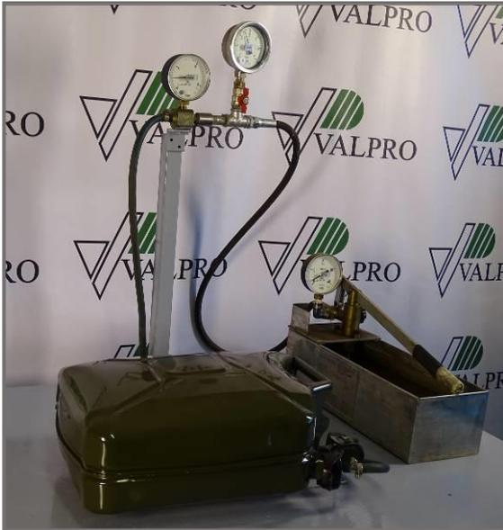
Der Kanister wird mit Wasser gefüllt und der Innendruck auf 1 oder 2,5 bar angehoben.
