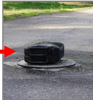
Der Kanister wird mit 10l Kraftstoff gefüllt und 120s in Flammen platziert.
