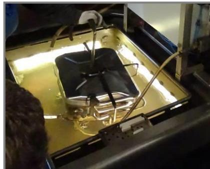
Dichtheitsprüfung - 0,3 bar
